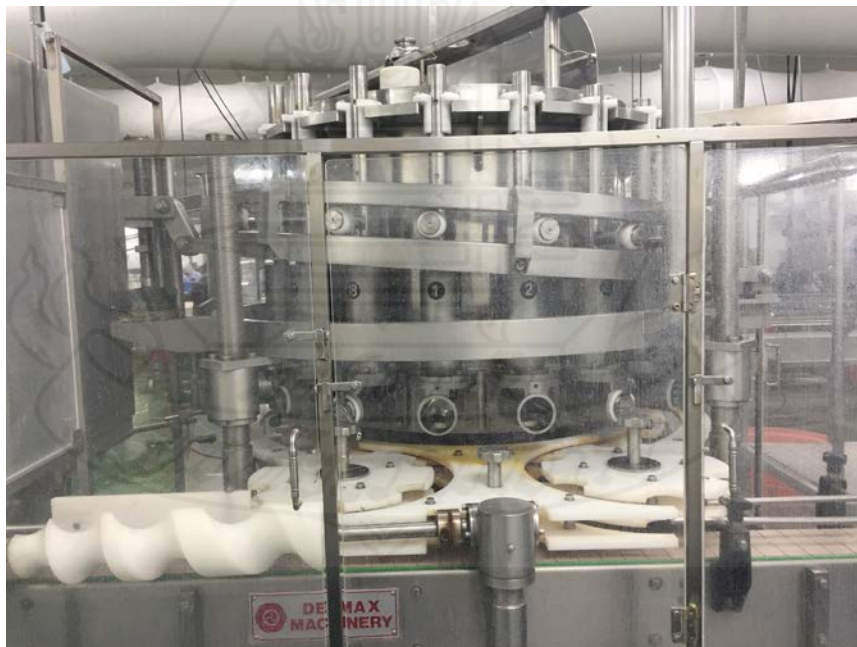
ภาพที่ 3.7 ภาพเครื่องบรรจุแบบใช้ลูกสูบ (Piston Filling Machine)
