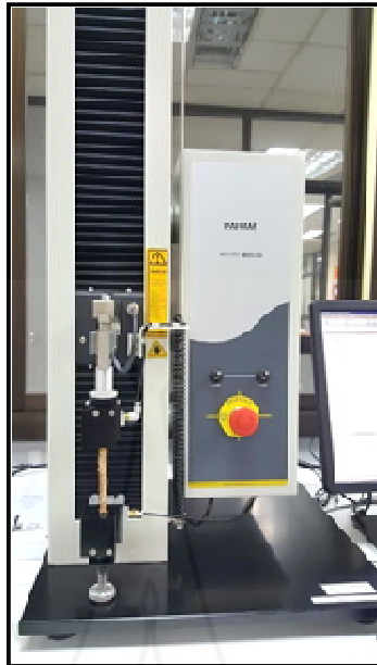
เครื่องทดสอบค่าความแข็งแรงต่อแรงดึง XLW(EC) Auto Tensile Tester ณ ห้องปฏิบัติการบรรจุภัณฑ์ สาขาวิชาวิทยาศาสตร์และเทคโนโลยี มหาวิทยาลัยสุโขทัยธรรมาธิราช
