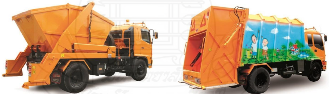
ภาพที่ 10 รถบรรทุกขยะชนิดถังคอนเทนเนอร์ และรถอัดท้าย
