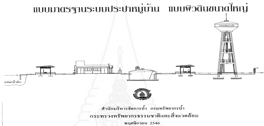
ภาพที่ 2.8 แสดงแบบมาตรฐานระบบประปาหมู่บ้าน แบบฟิวตินขนาดใหญ่
