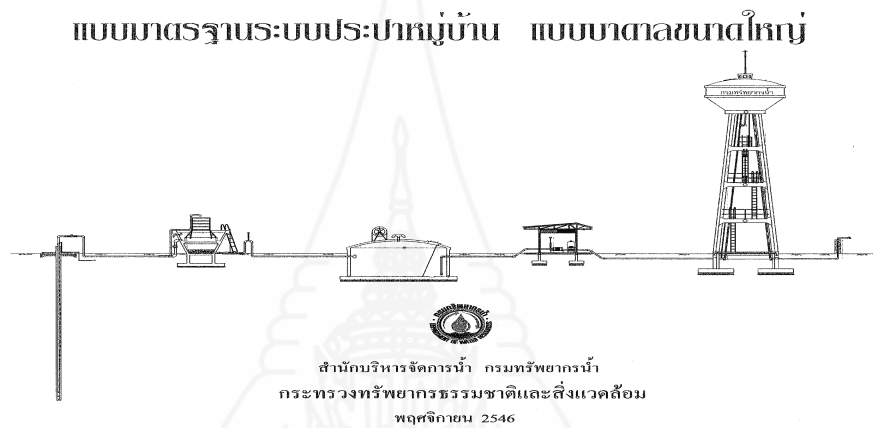
ภาพที่ 2.5 แสดงแบบมาตรฐานระบบประปาหมู่บ้าน แบบบาดาลขนาดใหญ่
