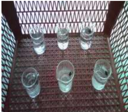
ภาพที่ ผค13 ล้างถ่านที่กระตุ้นแล้ว
