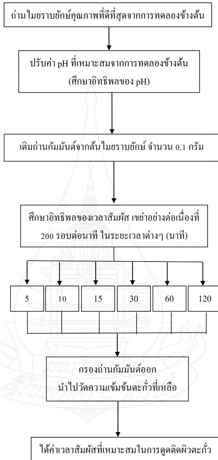
ภาพที่ 3.6 ขั้นตอนการศึกษาอิทธิพลของเวลาสัมผัสที่เหมาะสมในการทดลองแบบทีละเท (Batch Experiment)
