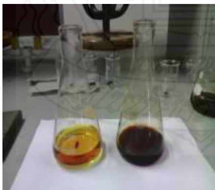
ภาพที่ ผค17 ไทเทรตไอโอดีนให้สีจางลง
