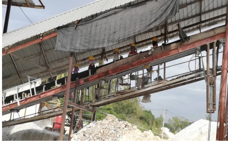
ภาพที่ 2.7 กระบวนการคัดแยกสิ่งปนเปื้อนระหว่างกระบวนการผลิต (Sorting)
