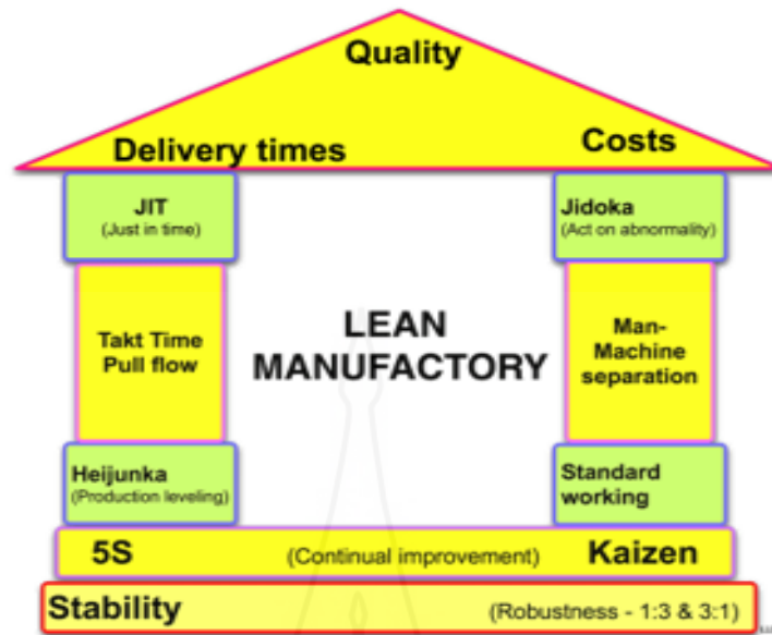
ภาพที่ 2.2 Lean House ระบบการผลิตแบบโตโยต้า (TPS)
