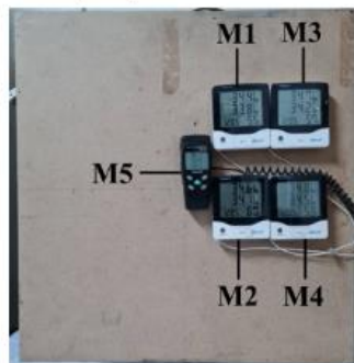
ภาพที่ 3.8 ตำแหน่งติดตั้งอุปกรณ์วัดอุณหภูมิและค่าแสงสว่าง
