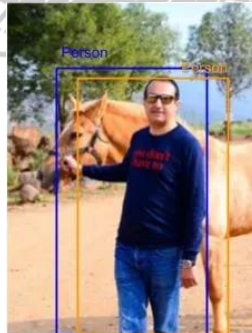
ภาพที่ 2.19 กำหนดเป็น TP เมื่อค่า IoU > 0.5 มีการทำนายคลาสคำตอบถูกต้อง
