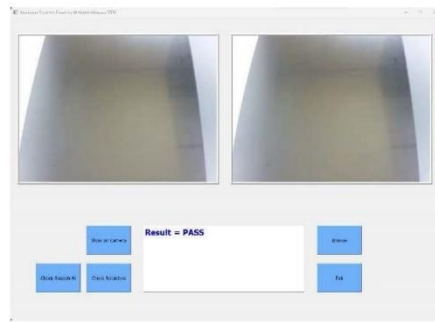
ภาพที่ 3 : ผลลัพธ์การตรวจสอบชิ้นงานที่ไม่มีรอยขีดข่วน
