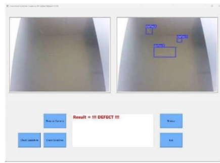
ภาพที่ 2 : ผลลัพธ์การตรวจสอบชิ้นงานที่มีรอยขีดข่วน
