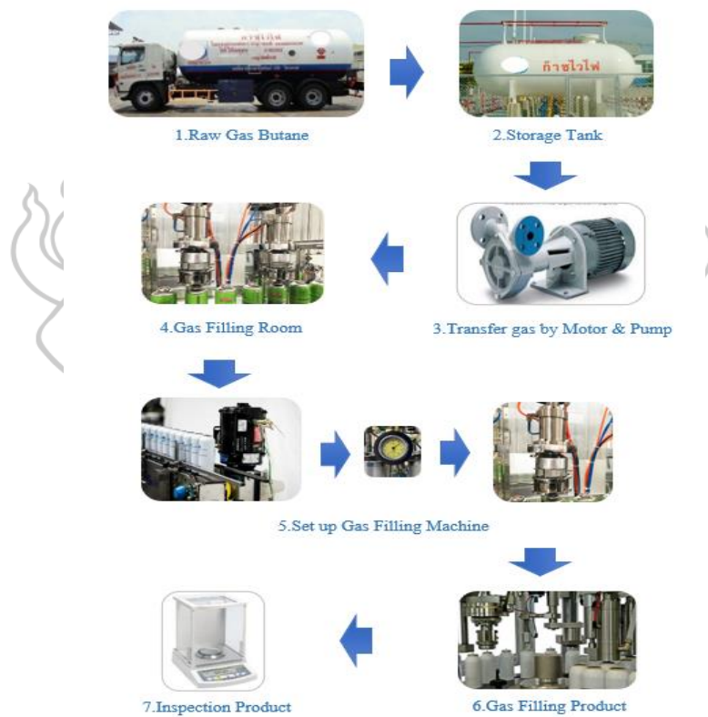
ภาพที่ 2.4 ขั้นตอนกระบวนการบรรจุก๊าซ
