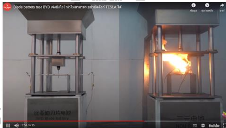
ภาพที่ 2.3 การทดสอบ Blade Battery โดยการทดลองเจาะแบบ Nail penetration test
