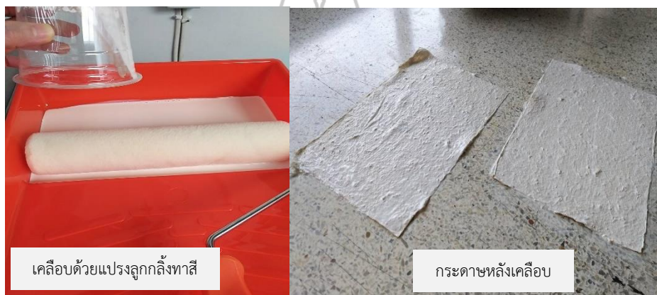
ภาพที่ 3.7 การทดลองครั้งที่ 1 เคลือบด้วยแปรงลูกกลิ้งทาสี
