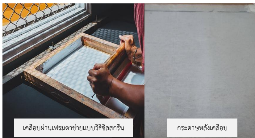
ภาพที่ 3.8 การทดลองครั้งที่ 2 เคลือบผ่านเฟรมตาข่ายแบบวิธีซิลสกรีน
