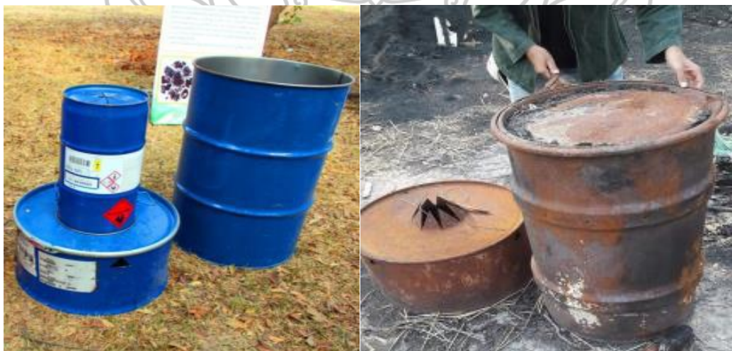
ภาพที่ 2.11 ลักษณะเตาไบโอชาร์ ขนาด 200 ลิตร
