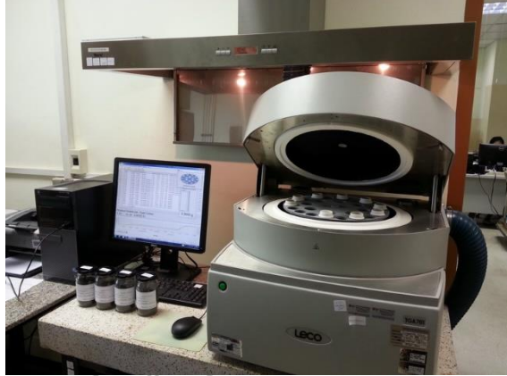
ภาพที่ 3.7 เครื่องวิเคราะห์ TGA ยี่ห้อ LECO รุ่น TGA-701
