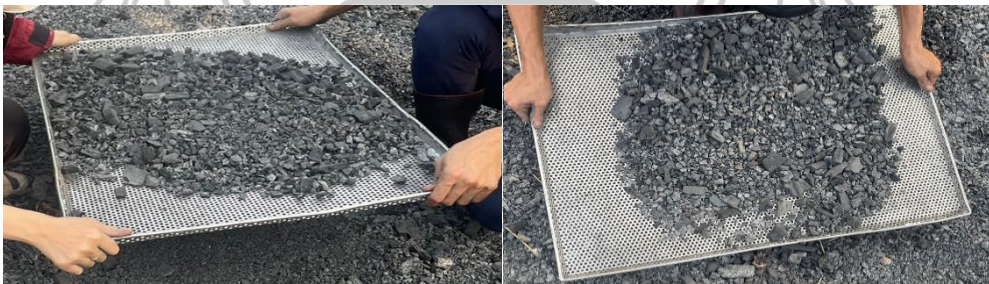
ภาพที่ 3.2 การนำเศษถ่านที่ใช้แล้ว มาทำการร่อนด้วยตะแกรง ขนาด 4 มิล
