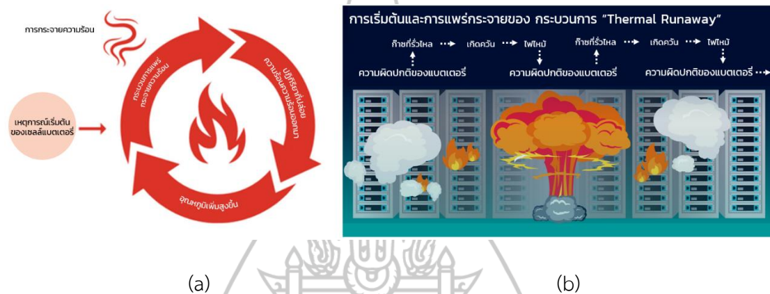
ภาพที่ 3.1 กระบวนการวิ่งหนีความร้อน Thermal Runaway (a)
