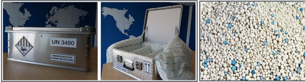
ภาพที่ 6.3 การบรรจุแบตเตอรี่ใช้งานแล้วหรือชำรุดเสียหาย
