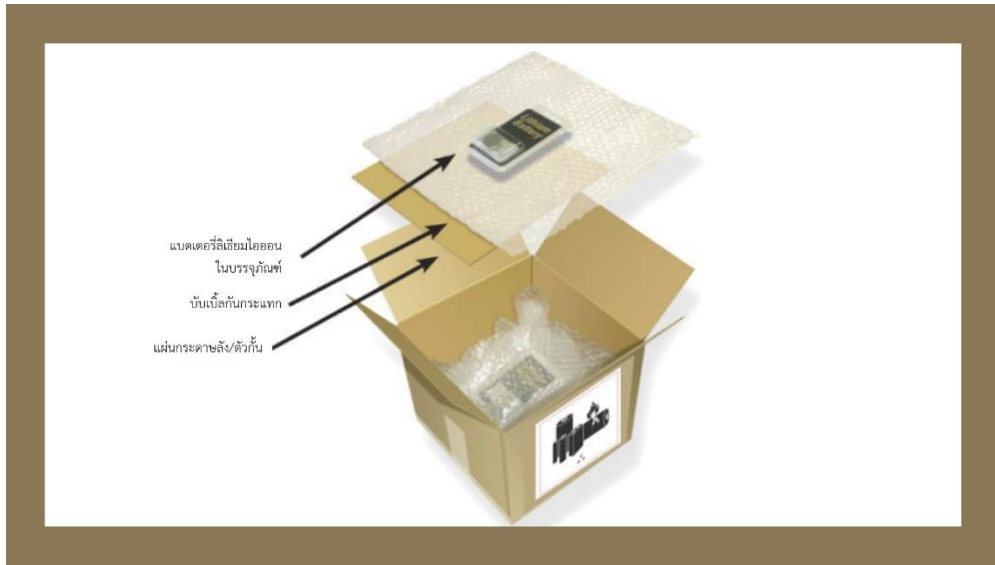
ภาพที่ 2.8 ตัวอย่างการบรรจุแบตเตอรี่ลิเทียมไอออน
