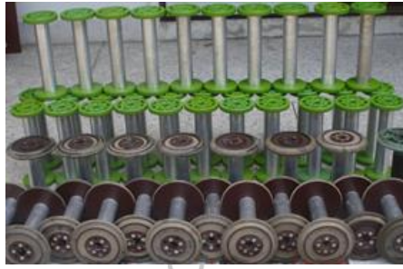
ภาพที่ 3.7 แกนหลอดเก็บเส้นใยและแผ่นประกอบแกนหลอดเก็บเส้น หรือ Bobbin
