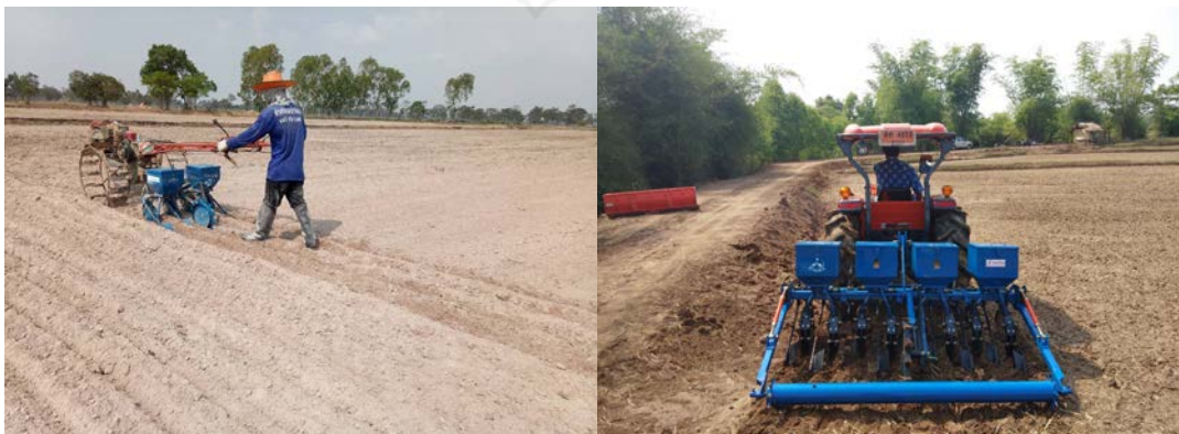
ภาพที่ 2.4 การทำงานของเครื่องหยอดข้าวแห้งพ่วงกับรถแทรกเตอร์และรถไถเดินตาม
