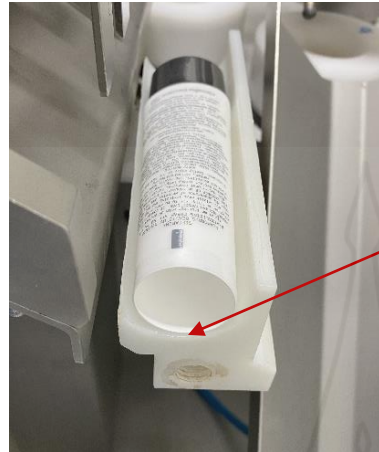
ภาพที่ 2.19 ลักษณะปลายหลอดสัมผัสกับอุปกรณ์ส่งหลอดรูปแบบที่ 2
