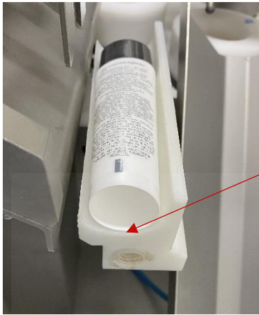
ภาพที่ 10 แสดงลักษณะปลายหลอดสัมผัสกับอุปกรณ์ส่งหลอดรูปแบบที่ 2
