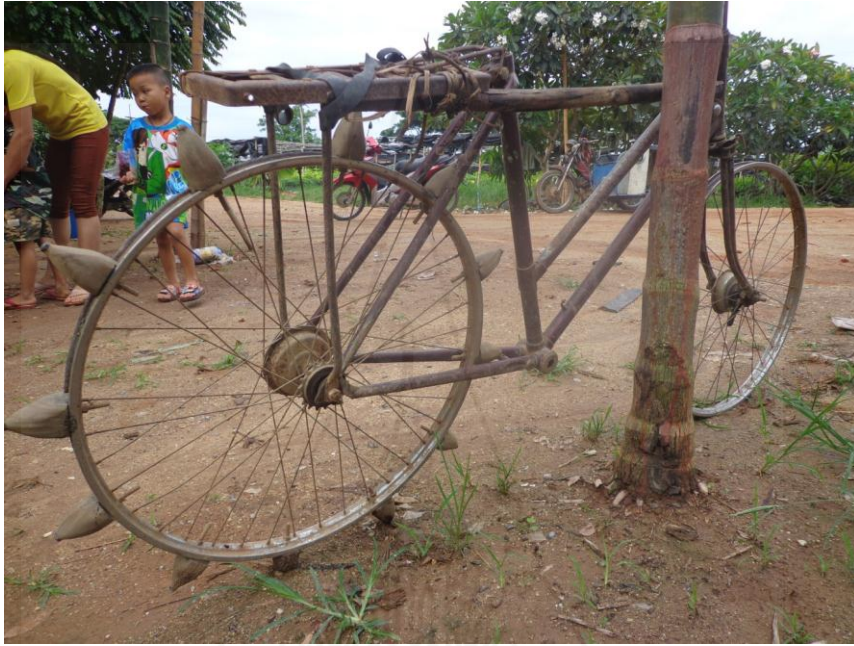
ภาพที่ 4.1 จักรยานเจาะหลุมปลูก
