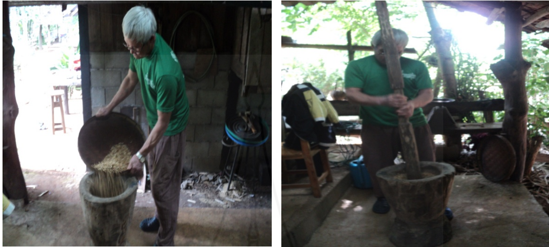
ภาพ 4.33 ลักษณะการสีเมล็ดกาแฟอาราบิก้าด้วยวิธีการตำเอาเปลือกออก โดยใช้แรงคนที่มา: สุริยา ศรีแสง (2557)
