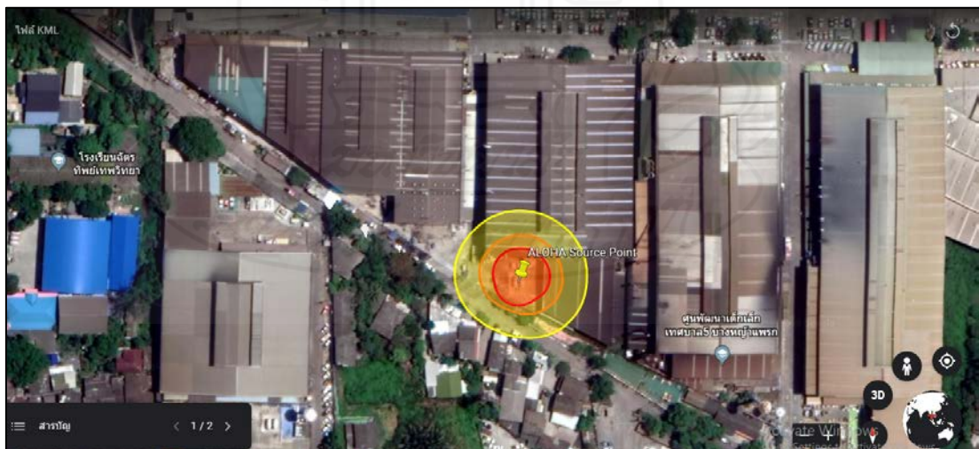
ภาพที่ 4.18 ระยะทางการแพร่กระจายของก๊าซโพรเพน ขณะมีการรั่วไหลโดยโปรแกรมกูเกิล เอิร์ธ
