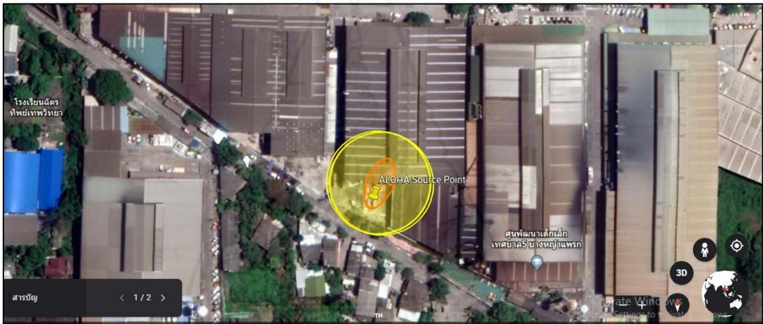
ภาพที่ 4.16 ระยะทางการแพร่กระจายของก๊าซโพรเพน ขณะมีการรั่วไหลโดยโปรแกรมกูเกิล เอิร์ธ
