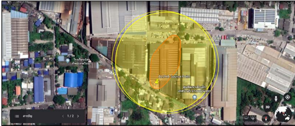
ภาพที่ 4.6 ระยะทางการแพร่กระจายของก๊าซโพรเพน ขณะมีการรั่วไหลโดยโปรแกรมกูเกิล เอิร์ธ
