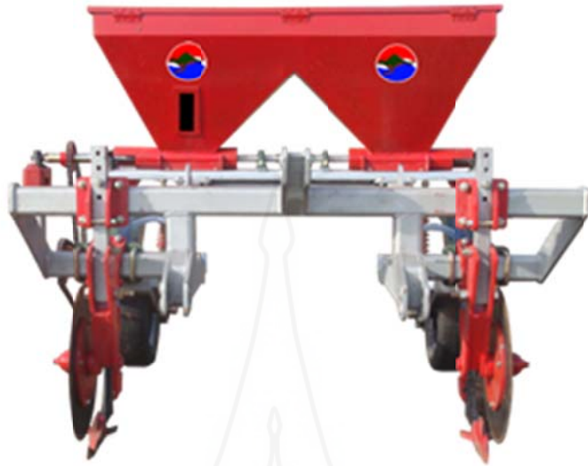
ภาพที่ 1.8 เครื่องพรวนดินใส่ปุ๋ยฝั้งกลบ M.P.I
