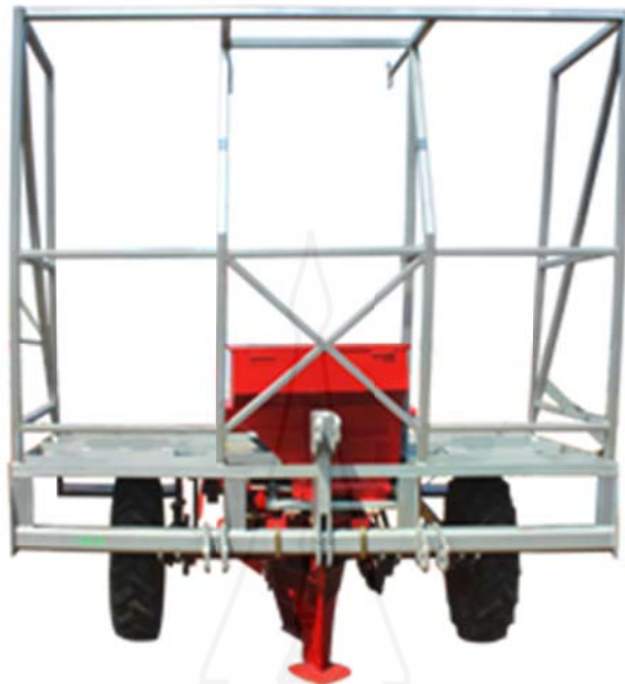
ภาพที่ 1.6 เครื่องปลูกชุดไฮดรอลิก ร่องเดี่ยว
