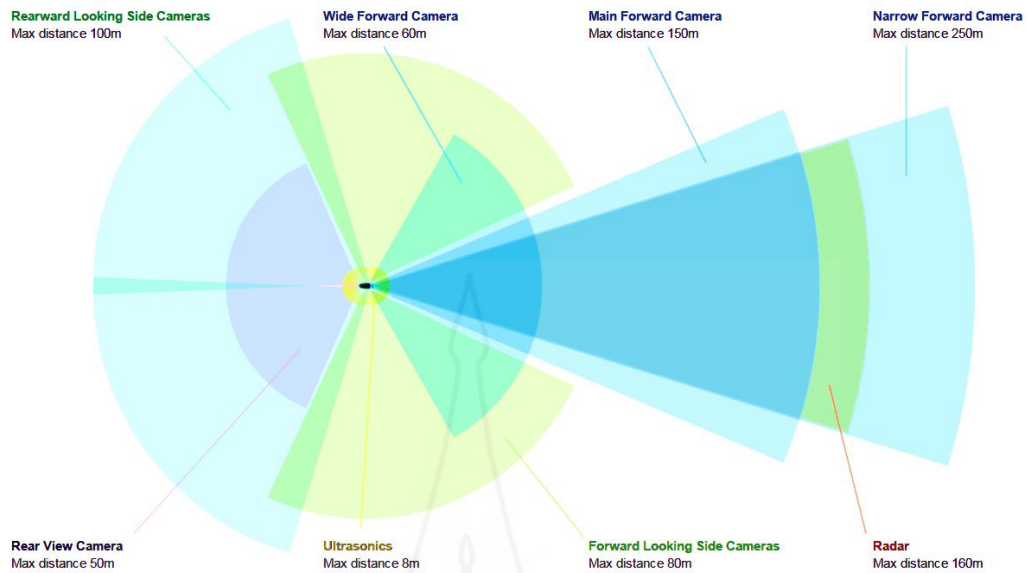
ภาพที่ 2.1 ตัวอย่างการใช้เซนเซอร์ คลื่นเสียงและกล้อง 10
