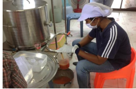
ภาพที่ 2.9 ขั้นตอนพักข้าวที่ปั่นแล้วเข้าเครื่อง สูบวนการผสมเป็นน้ำสกัด
