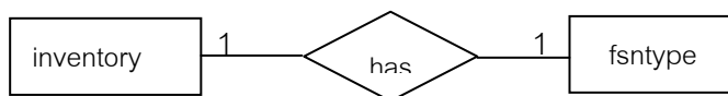
ภาพที่ 4.13 แสดงความสัมพันธ์ของเอนทิตี inventory กับเอนทิตี fsntype
