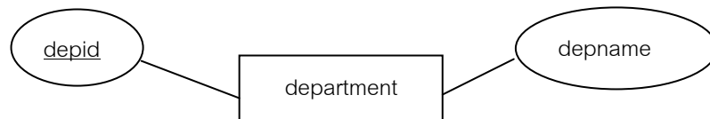
ภาพที่ 4.5 แสดงแอตทริบิวต์ของเอนทิตี department
