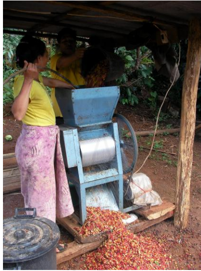
ภาพที่ 7 การโม่เปลือกผลสดของเกษตรกรรายย่อย
