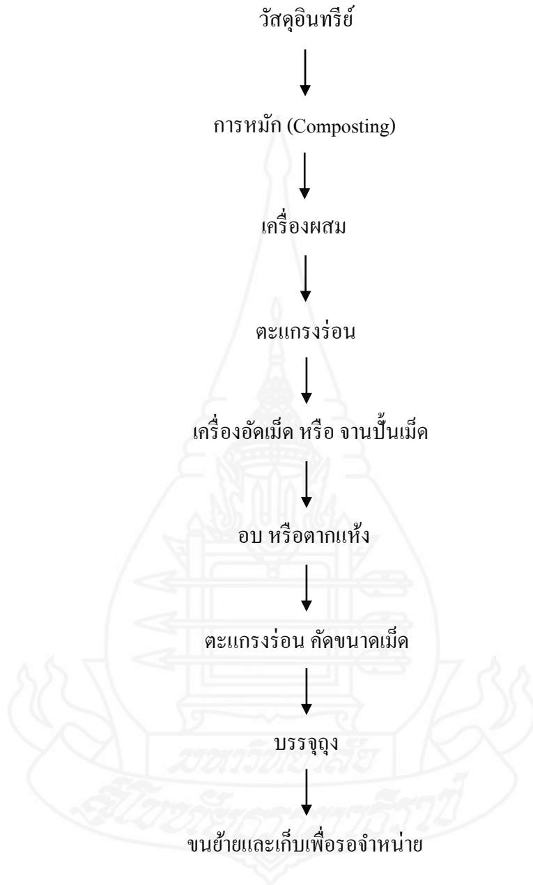
ภาพที่ 2.1 แผนผังกระบวนการผลิตปุ๋ยอินทรีย์ชนิดเม็ด/อัดเม็ด
