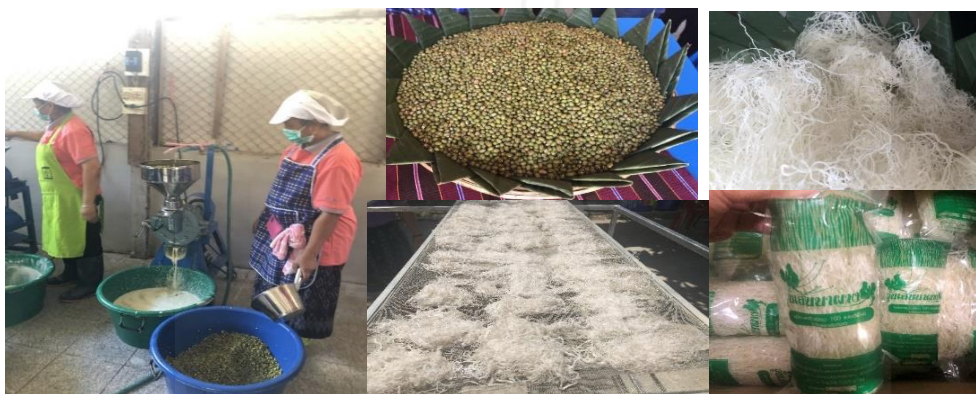
ภาพที่ 4.15 กระบวนการผลิตวุ้นเส้นจากถั่วเขียว ซึ่งทางกลุ่มกำลังพัฒนาเพื่อให้ได้โรงงานผลิตที่สมัย พร้อมทั้งนำกากมาแปรรูปเป็นผลิตภัณฑ์ต่อเนื่อง
