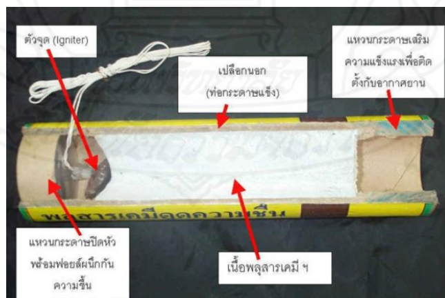
ภาพที่ 2.7 ส่วนประกอบของแท่งพลุสารดูดความชื้นที่ผลิตโดยกองทัพอากาศ
