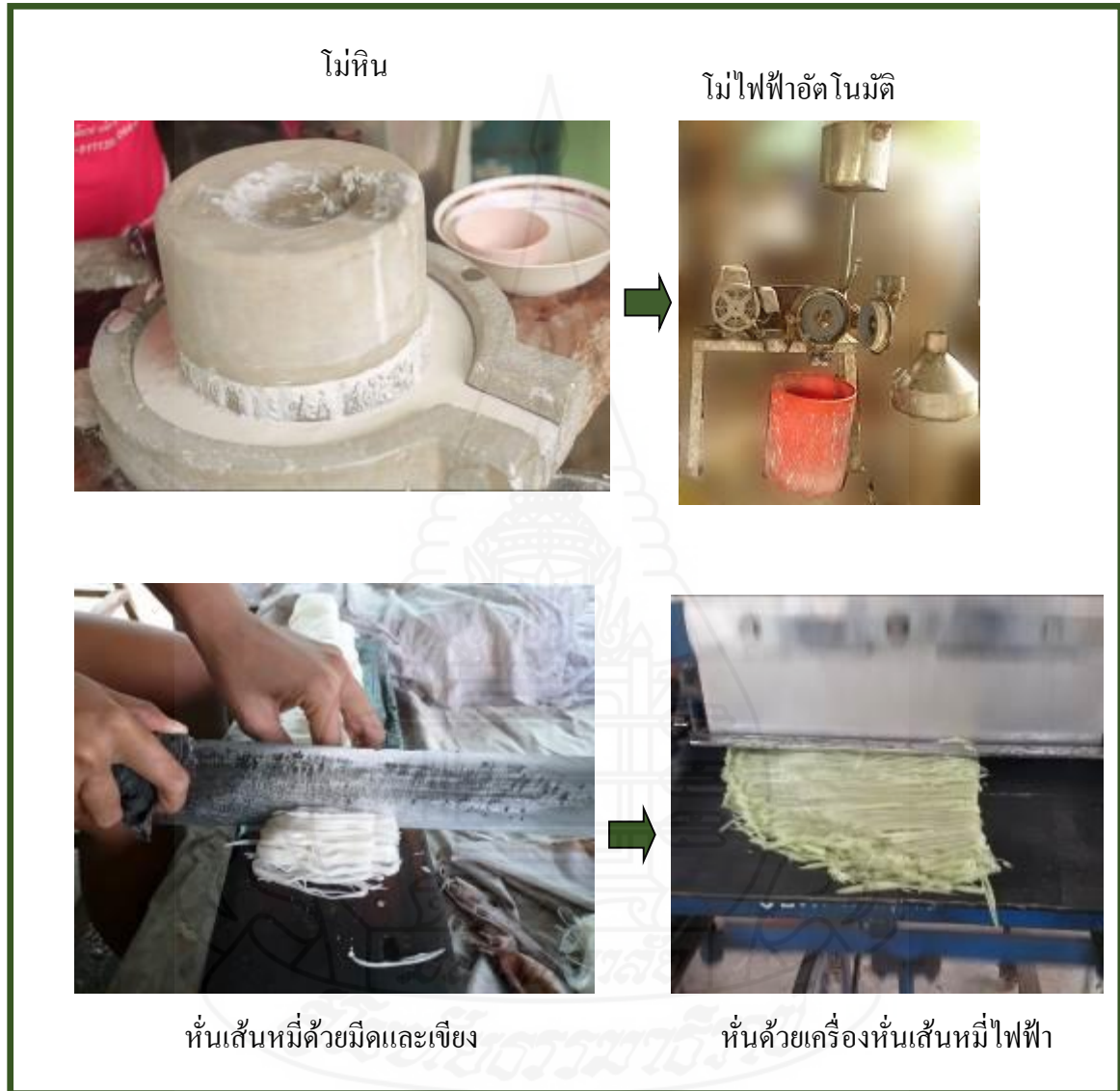
ภาพที่ 4.5 การประยุกต์ใช้ภูมิปัญญาด้านอุปกรณ์เครื่องมือการผลิตของวิสาหกิจชุมชนกลุ่มแม่บ้านเกษตรกรทำเส้นหมี่บ้านน้ำจ่า
