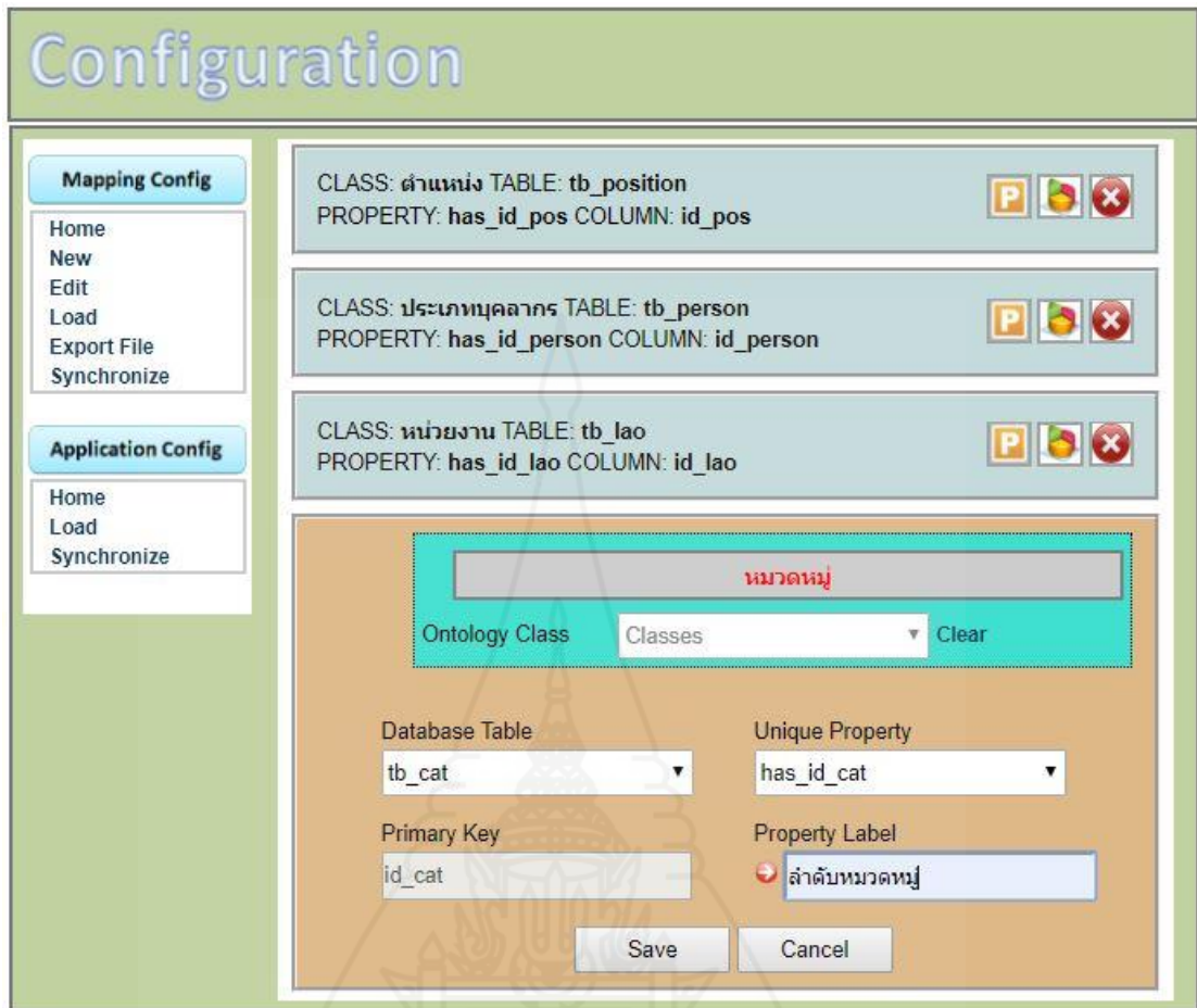
ภาพที่ 3.25 แสดงการกำหนดความสัมพันธ์ของคลาสหมวดหมู่กับตาราง tb_cat
