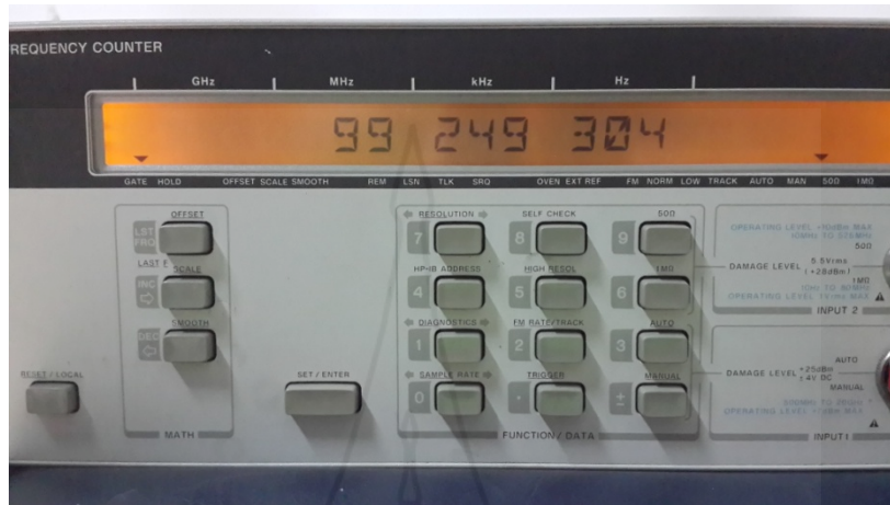
ภาพที่ 4.23 การใช้เครื่องนับความถี่วัดสัญญาณความถี่แบนด์แคป 99.25 MHz เชื่อมต่อกับบอร์ด ET-dsPIC33WEB V1
