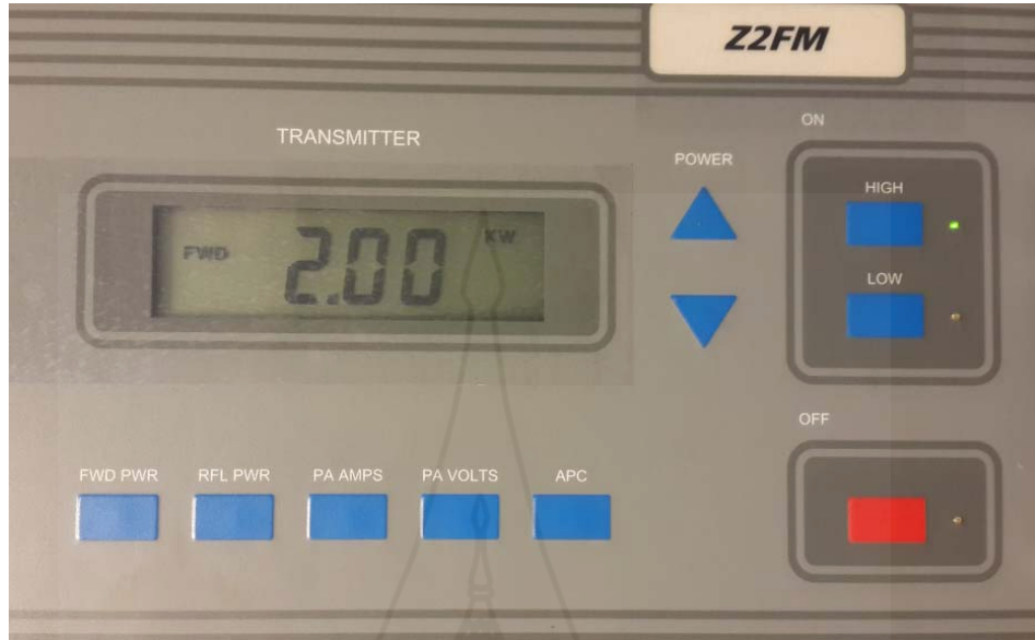
ภาพที่ 2.6 จอแสดงผลและปุ่มควบคุมการทำงานของเครื่องส่งวิทยุ
