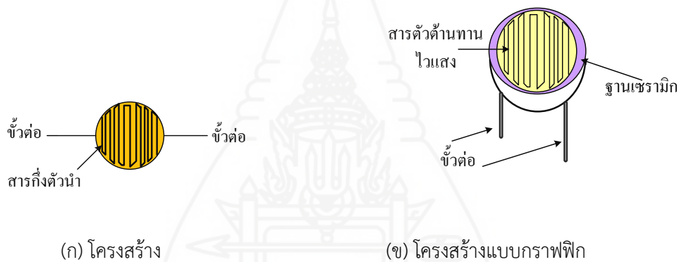
ภาพที่ 5.14 โครงสร้างของตัวต้านทานเปลี่ยนค่าตามแสง
