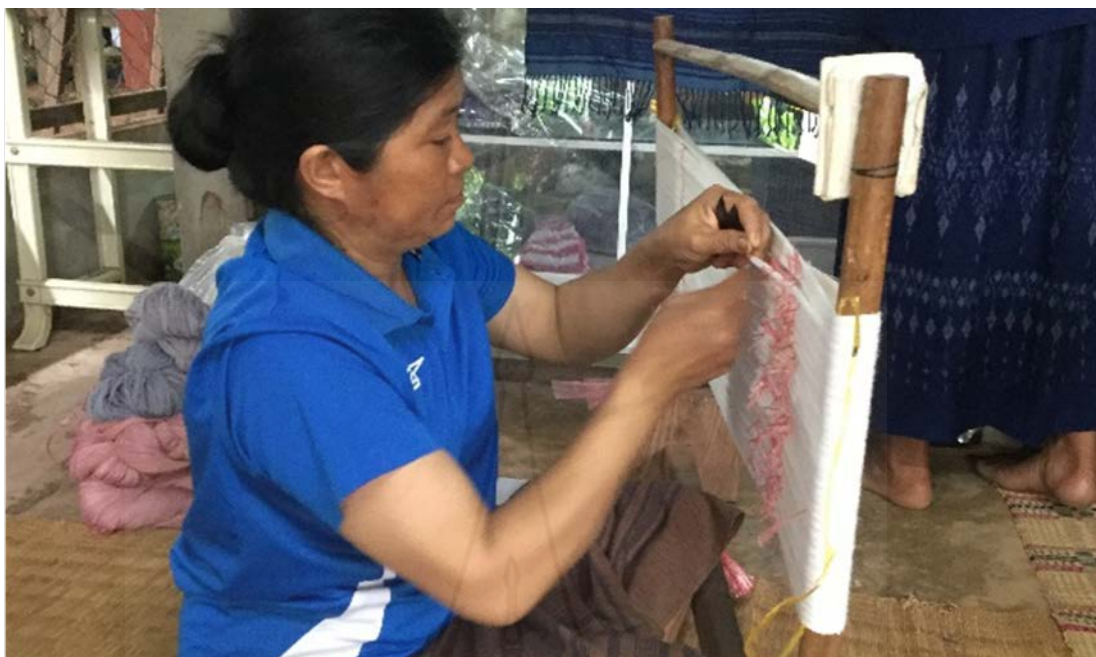
ภาพที่ 2.5 การทำลวดลายมัดหมี่ก่อนนำไปย้อม
