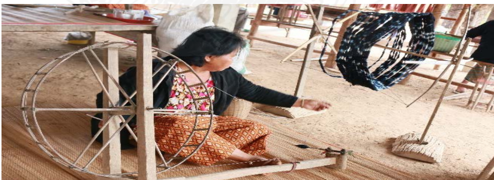
ภาพที่ 2.33 กงหลา ที่ชาวบ้านกำลังปั่นด้ายใส่หลอด
