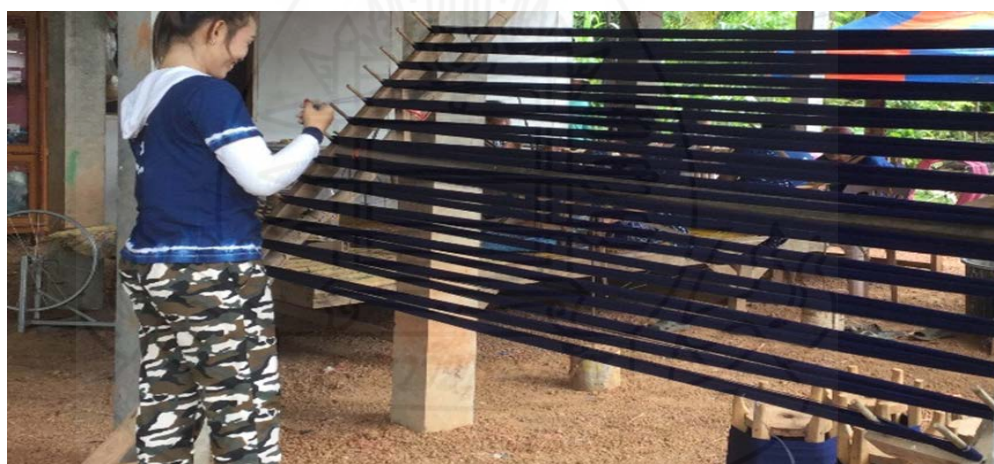
ภาพที่ 2.35 การคันเครื่องทอหรือทำเส้นยืน
