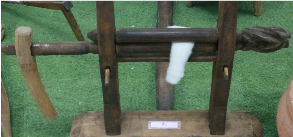
ภาพที่ 2.25 การอ้วฝ้ายให้เป็นเส้นใยและแยกเมล็ดออกจากปุยฝ้าย
