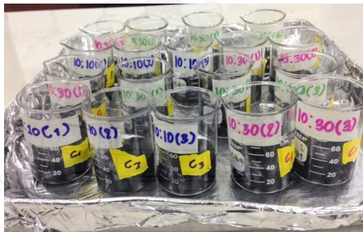
ภาพที่ 3.7 การล้างสาร KOH เพื่อให้ pH เป็นกลาง
