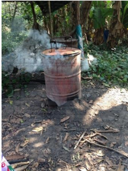
ภาพที่ 3.2 การเผาถ่านภายในถังขนาด 200 ลิตร
