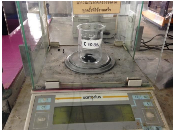
ภาพที่ 3.10 การชั่งน้ำหนักถ่านบนเครื่องชั่งทศนิยม 4 ตำแหน่ง
