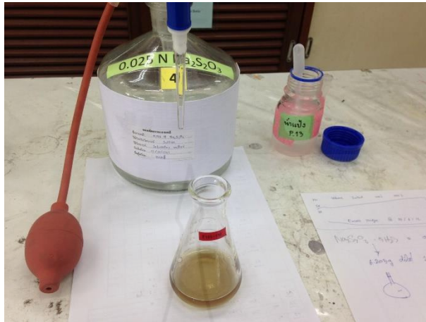
ภาพที่ 3.12 การไทเทรตน้ำไอโอดีนจากถ่านกัมมันต์จากกะลามะพร้าวและถ่านกัมมันต์จากกะลาปาล์มกับสารละลายไฮโอซัลเฟต
