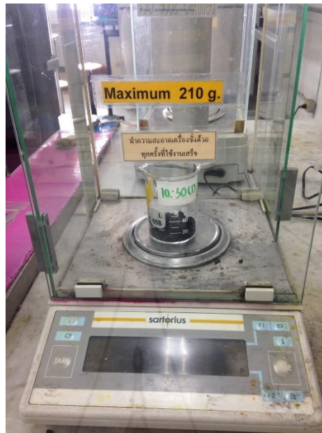
ภาพที่ 3.5 การชั่งน้ำหนักถ่านบนเครื่องชั่งตศนิยม 4 ตำแหน่ง
