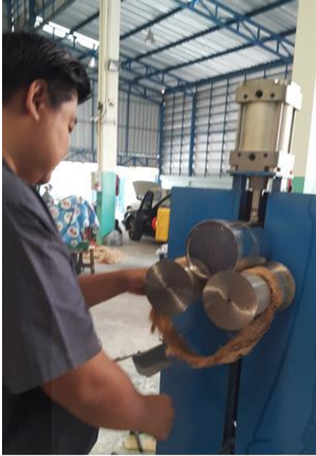
(ก) การบีบอัดเส้นใยด้วยชุดลูกกลิ้ง
