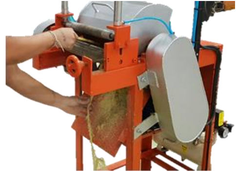
(ข) ลักษณะการทำงานของเครื่องตีแยกเส้นใย
