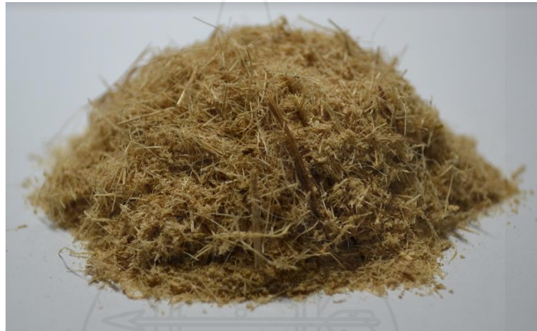
ภาพที่ 4.6 เศษผงและเศษเส้นใยขนาดเล็กที่หลุดออกมาจากเครื่องบีบเส้นใย
