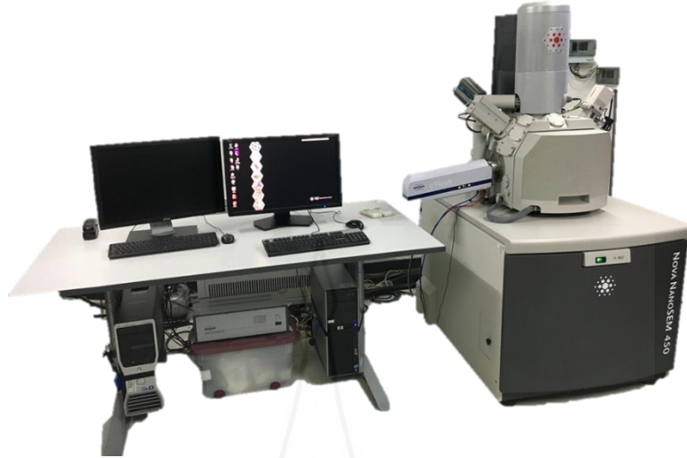
ภาพที่ 3.3 กล้องจุลทรรศน์อิเล็กตรอนชนิดส่องกราดแบบฟิลด์อิมชัน
