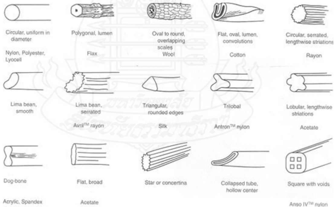
ภาพที่ 2.7 ลักษณะภาคตัดขวางและผิวของเส้นใยชนิดต่างๆ
