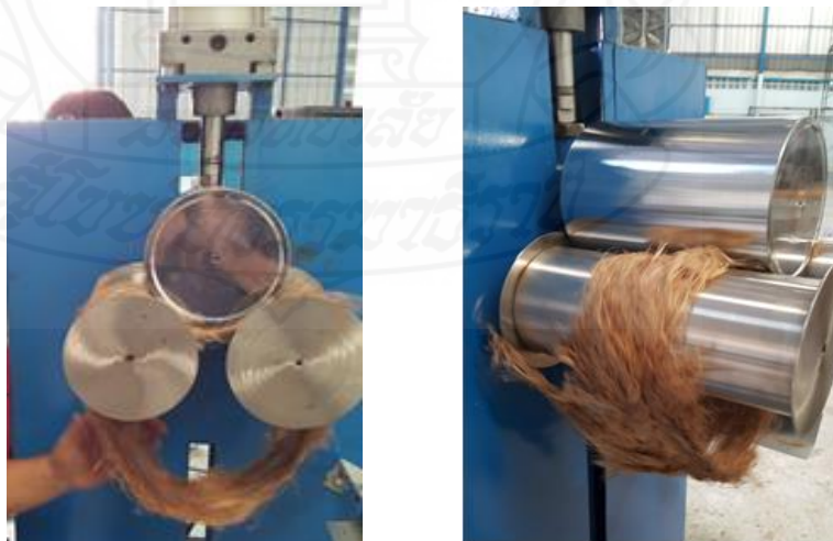
ภาพที่ 4.2 เครื่องจักรปรับปรุงความละเอียดของเส้นใย
