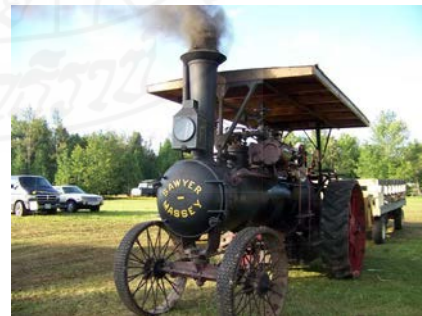
ภาพที่ 5.1 รถแทรกเตอร์ในสมัยแรกที่นำเครื่องจักรไอน้ำมาเป็นเครื่องต้นกำลัง
