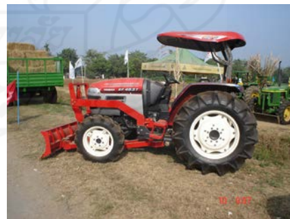
ภาพที่ 5.9 รถแทรกเตอร์แบบขับเคลื่อน 4 ล้อที่มีขนาดของล้อหน้าเล็กกว่าล้อหลัง
