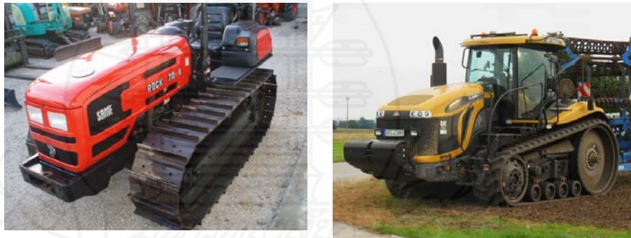
ภาพที่ 5.11 รถแทรกเตอร์ล้อเหล็กหรือล้อตีนตะขาบ
