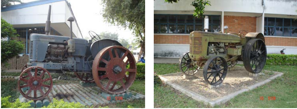
ภาพที่ 5.2 รถแทรกเตอร์ที่มีการพัฒนานำเครื่องยนต์ดีเซลมาใช้เป็นเครื่องต้นกำลัง และมีลักษณะล้อเป็นเหล็ก
