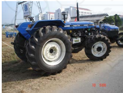
ภาพที่ 5.9 รถแทรกเตอร์แบบขับเคลื่อน 4 ล้อที่มีขนาดของล้อหน้าเล็กกว่าล้อหลัง
