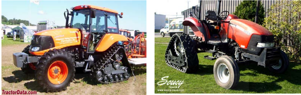
ภาพที่ 5.12 รถแทรกเตอร์แบบกึ่งล้อตีนตะขาบ
