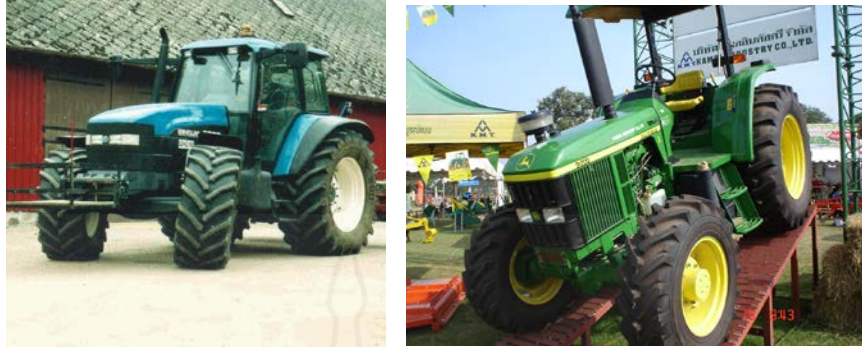
ภาพที่ 5.10 รถแทรกเตอร์แบบขับเคลื่อน 4 ล้อ ที่มีขนาดของล้อทั้ง 4 ล้อเท่ากัน
