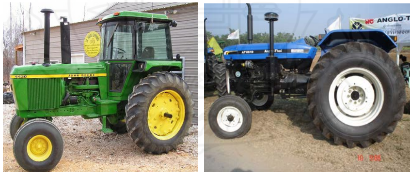
ภาพที่ 5.5 รถแทรกเตอร์แบบ Standard Tread
