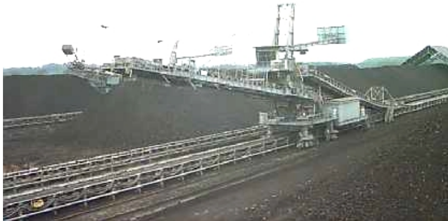
ภาพที่ 2.2 สายพานลำเลียงถ่านหินลิกไนต์จากเหมืองแม่เมาะ ไปยังกองถ่านหิน
