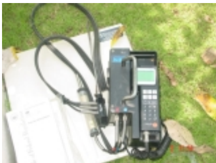
GAS ANALYZER (วัด % O 2 , CO 2 ในปล่อง
