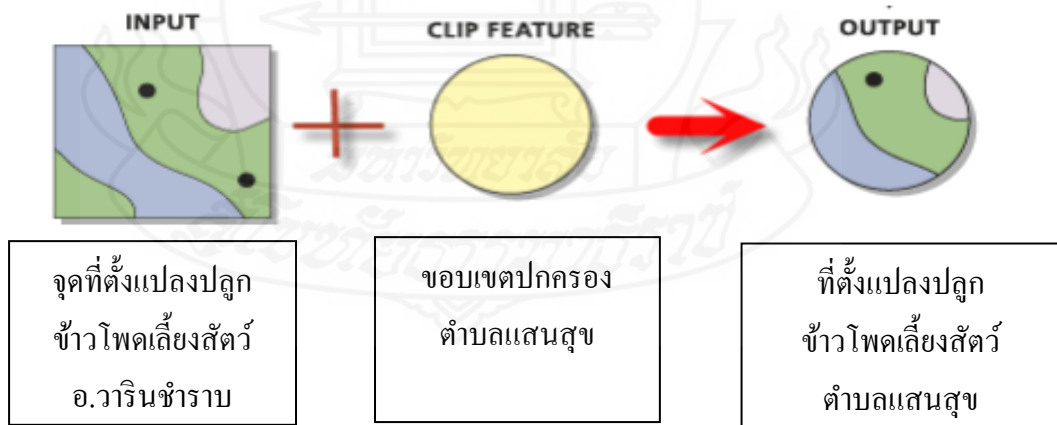
ภาพ ข.4 หลักการทำงานด้วยชุดคำสั่ง clip ระบบสารสนเทศทางภูมิศาสตร์ (GIS)
