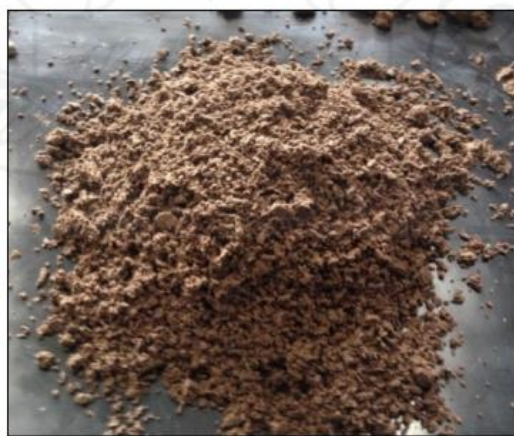
ภาพที่ 4.35 กากตะกอนดีเคเนเตอร์หลังร้อนผ่านตะแกรง ที่มา: มหาวิทยาลัยสงขลานครินทร์, 2558
