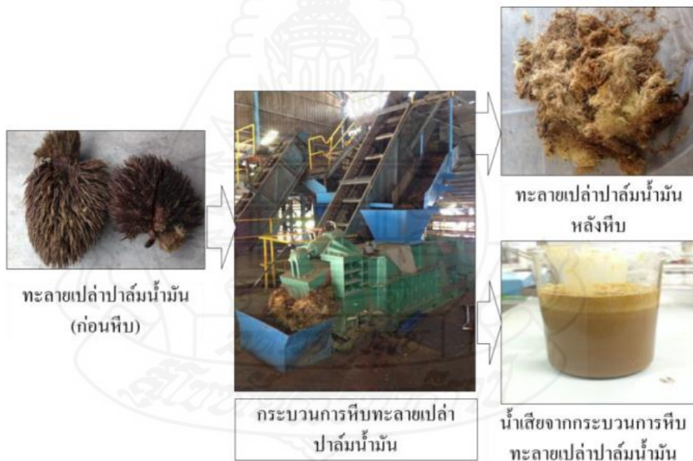
ภาพที่ 4.32 กระบวนการหีบทะเลสาปาล์มน้ำมัน
