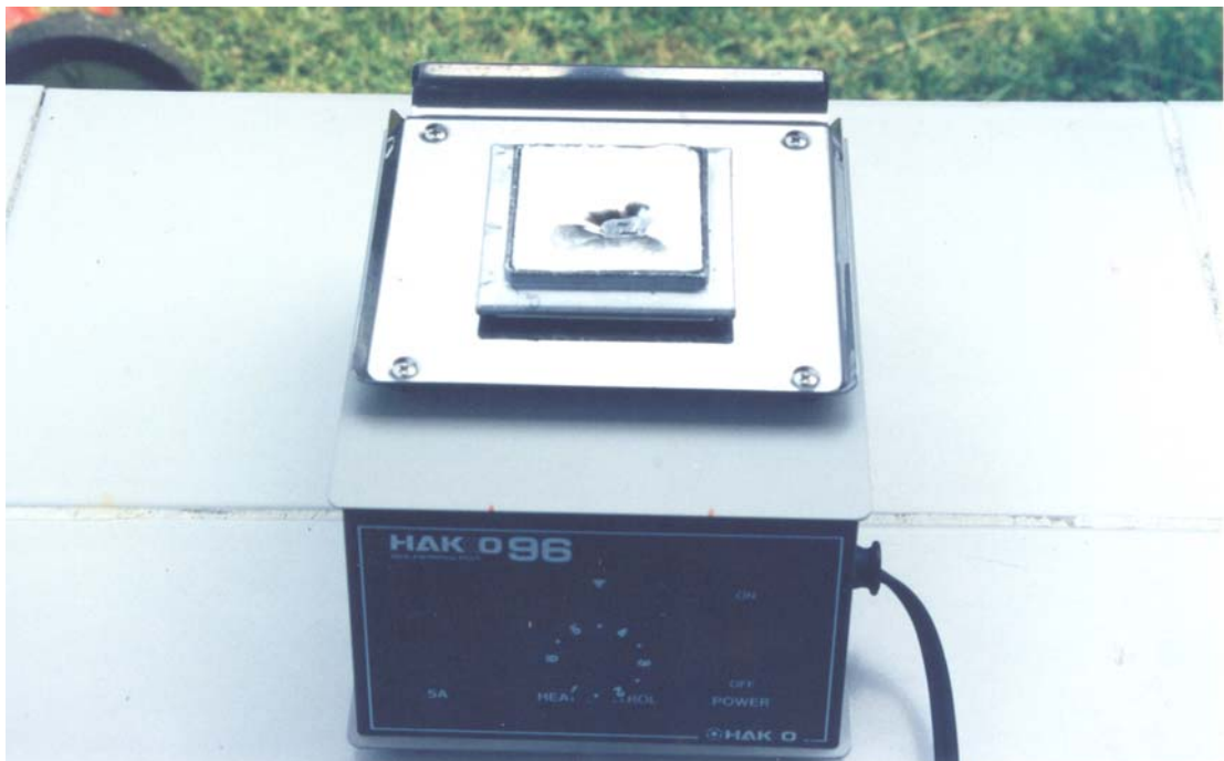
ภาพที่ 24 แสดงเครื่องหลอมตะกั่วที่สามารถควบคุมอุณหภูมิได้
