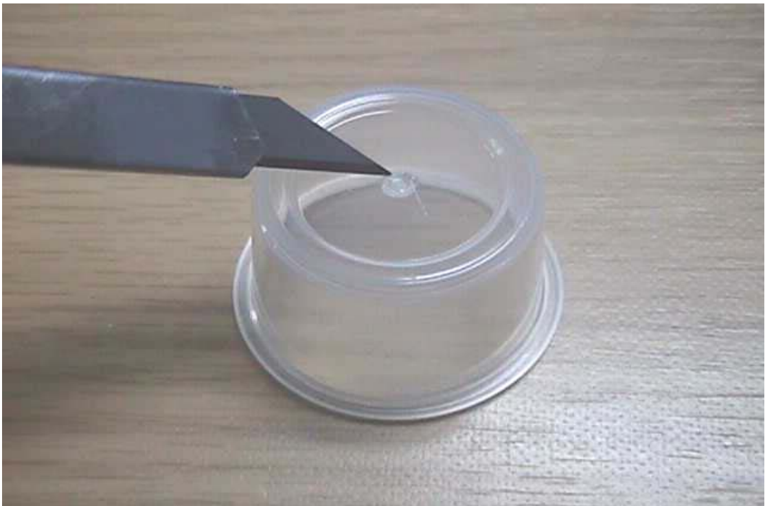
ภาพที่ 14 แสดงการใช้ใบมีดเจาะรูตรงก้นภาชนะ
