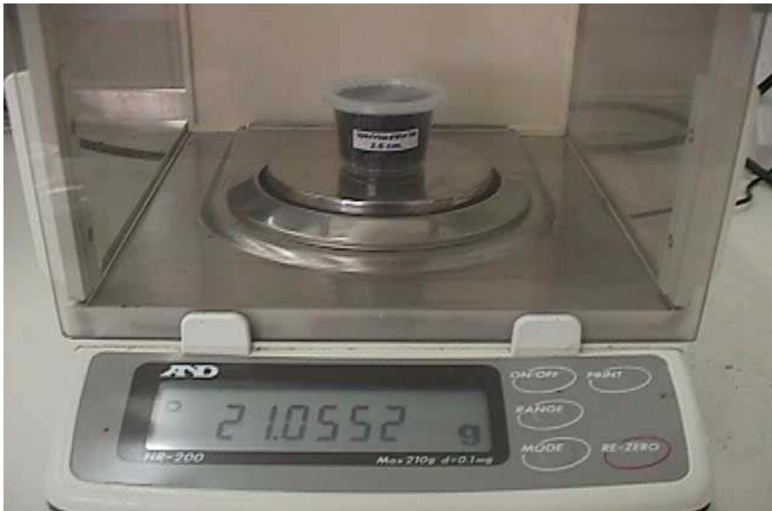
ภาพที่ 23 แสดงการชั่งน้ำหนักของวัสดุรองที่ชั้นความหนา 2.5 cm.
