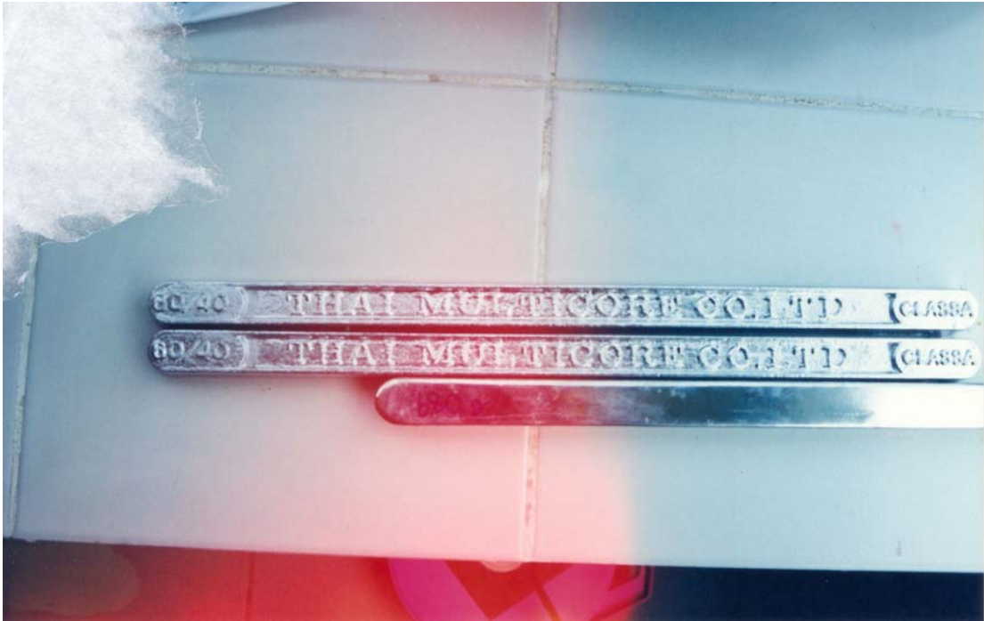
ภาพที่ 29 แสดงตะกั่วแท่ง ชนิด 60/40 ขนาด 680 กรัม ที่ใช้ในการทดลอง
