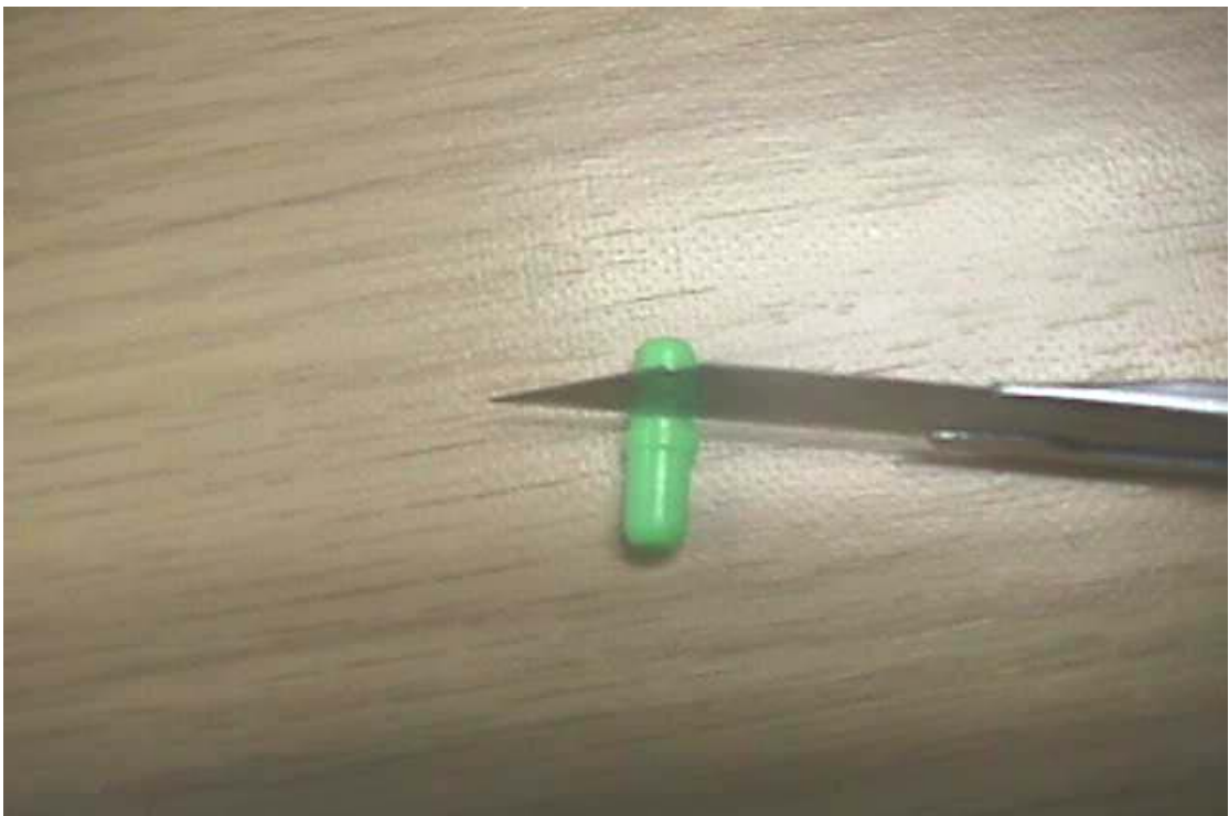
ภาพที่ 12 แสดงการใช้ใบมีดตัดปลายในส่วนของข้อต่อให้สั้นลง
