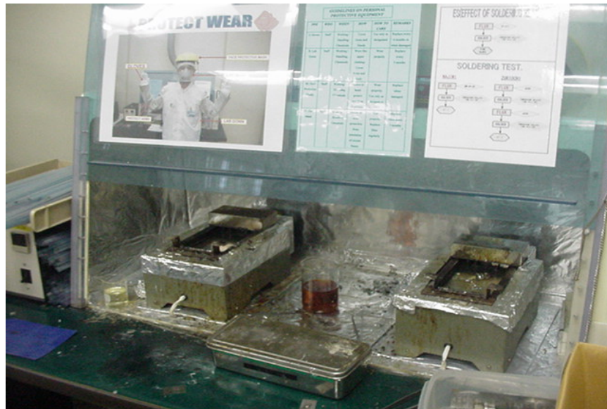
ภาพที่ 2.7 เครื่องหลอมตะกั่วชนิดเป่าหลอม
