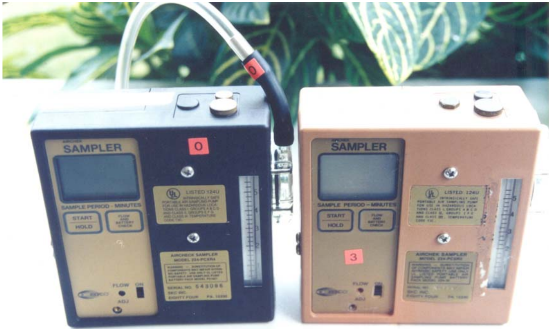
ภาพที่ 25 แสดง Personal Pump ที่ใช้ในการเก็บตัวอย่างเพื่อเขียนแบบการหายใจของคน
