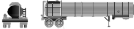
ภาพที่ 5.15 ลักษณะรถขนส่งของเสียประเภทสารกักคร่อน
