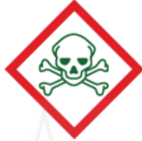
ภาพที่ 5.9 สัญลักษณ์ของเสียอันตรายประเภทเป็นพิษเฉียบพลันที่มีความเป็นพิษสูง
