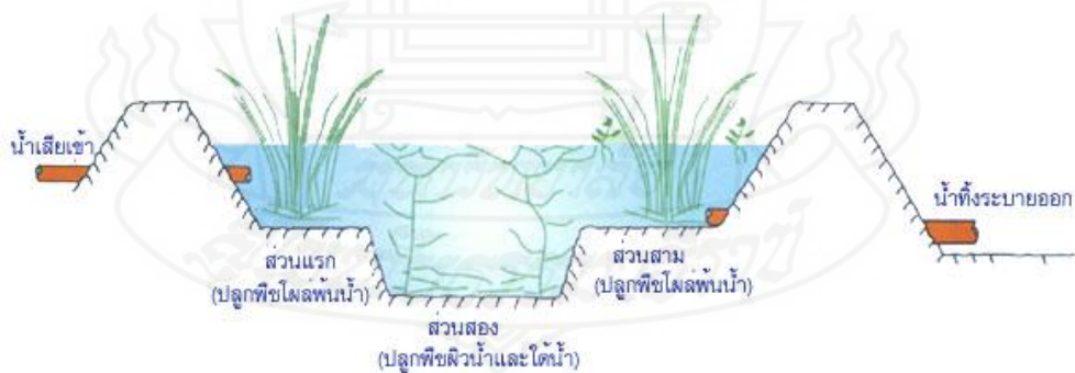
ภาพที่ 2.23 ระบบบึงประดิษฐ์แบบ Free Water Surface Wetland (FWS) 1 บ่อ ที่มา: กรมควบคุมมลพิษ, 2555
