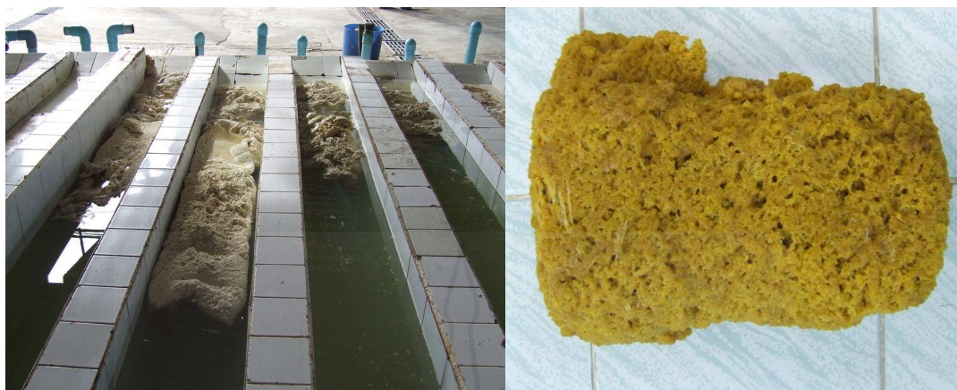
ภาพที่ 2.5 การจับตัวของก้อนขางสกิม ในรางทางน้ำยาง และก้อนขางสกิม ที่มา: ศูนย์เทคโนโลยีโลหะและวัสดุแห่งชาติ (MTEC), 2554
