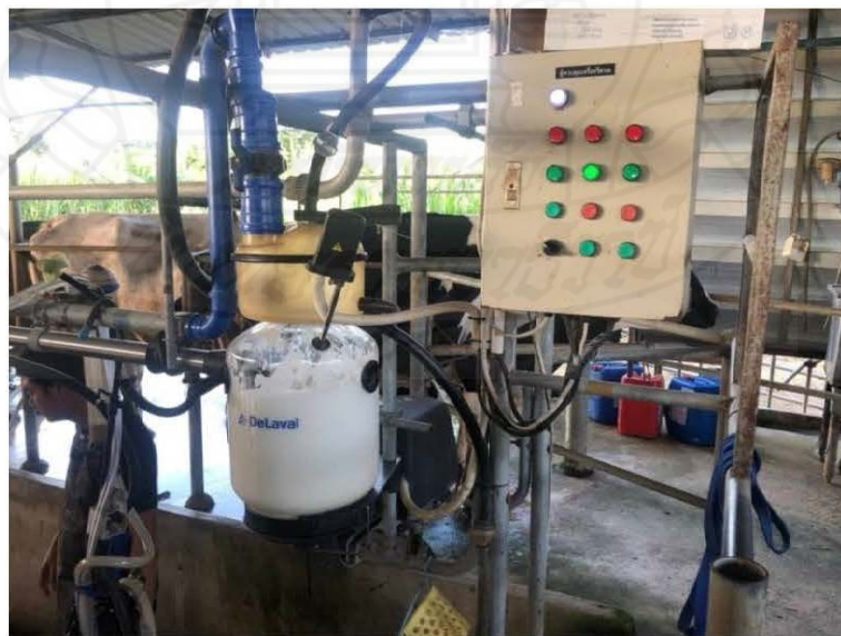
ภาพที่ 4.5 เครื่องรีดนม (pipe line)
