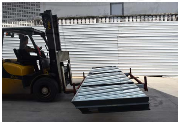
ภาพที่ 4.31 การเคลื่อนย้ายผลิตภัณฑ์สำเร็จเพื่อนำไปจัดเก็บยังลานบ่มโดยใช้รถยก
