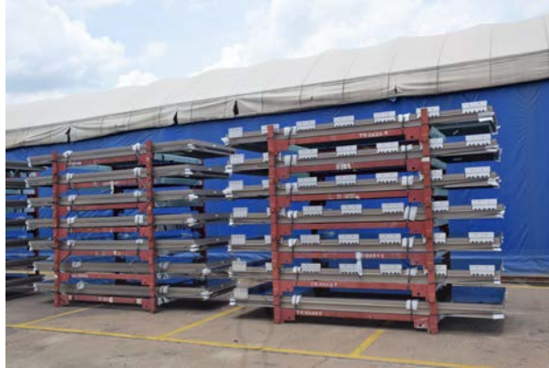
ภาพที่ 4.10 การจัดเก็บผลิตภัณฑ์สำเร็จหลังยาซิลิโคนในลานบ่มซิลิโคน
