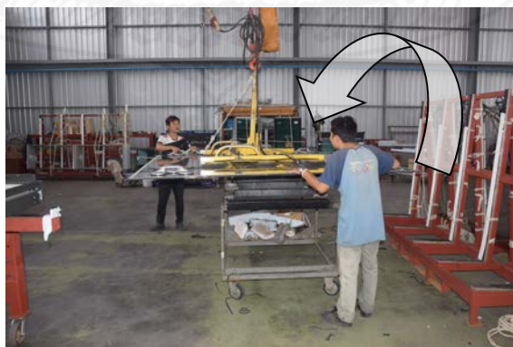
ภาพที่ 4.20 การเตรียมกระจกสำหรับติดตั้งบนกรอบอลูมิเนียม
