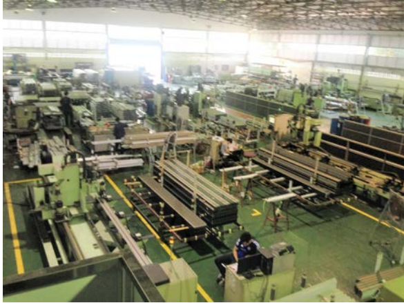
ภาพที่ 2.1 หน่วยงานตัด กัด บาก เจาะรู อลูมิเนียมเส้น
