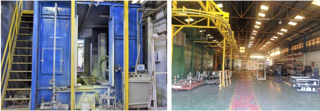
ภาพที่ 2.3 หน่วยงานเคลือบผิววัสดุอลูมิเนียมด้วยสีน้ำและสีผงตามลำดับ
