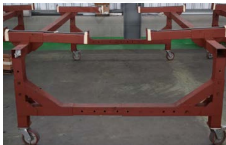
ภาพที่ 4.34 รถเข็นสำหรับสถานีนงานติดตั้งกระจกและยาซิลิโคน
