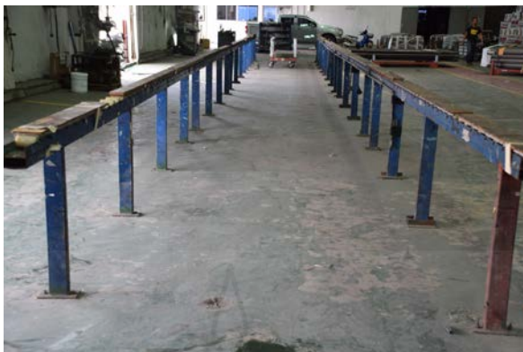
ภาพที่ 2.5 รางลูกกลิ้งลำเลียงของสายการติดตั้งกระจก โรงงาน 2
