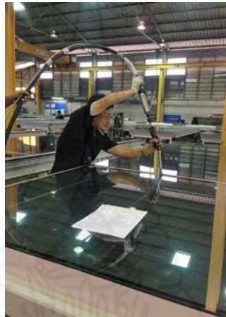
ภาพที่ 4.25 การฉีดซิลิโคนชนิด 2 ส่วนผสมด้วยเครื่องผสมซิลิโคน
