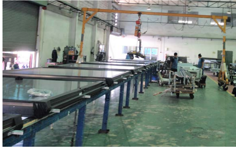
ภาพที่ 4.22 การติดตั้งกระจกลงในกรอบอลูมิเนียมบนรางลูกกลิ้งลำเลียง
