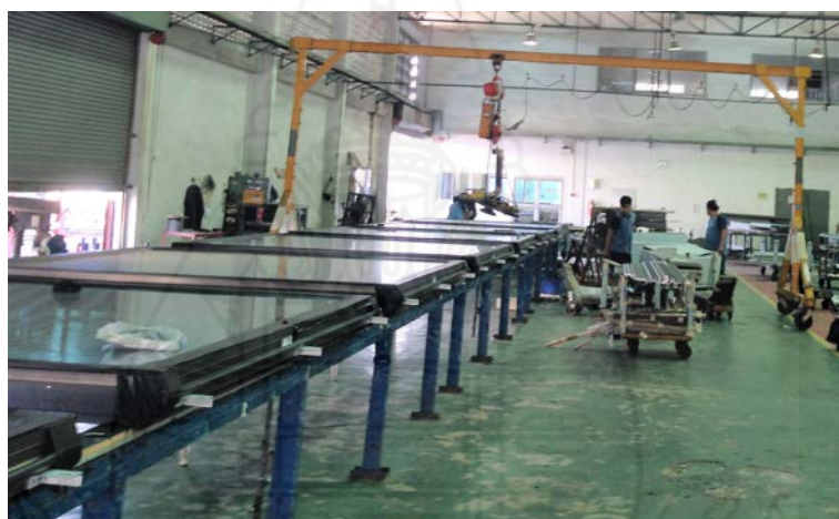
ภาพที่ 4.38 การลำเลียงกระจกเพื่อนำไปติดตั้งในกรอบอลูมิเนียมที่เตรียมไว้บนรางลูกกลิ้งลำเลียง
