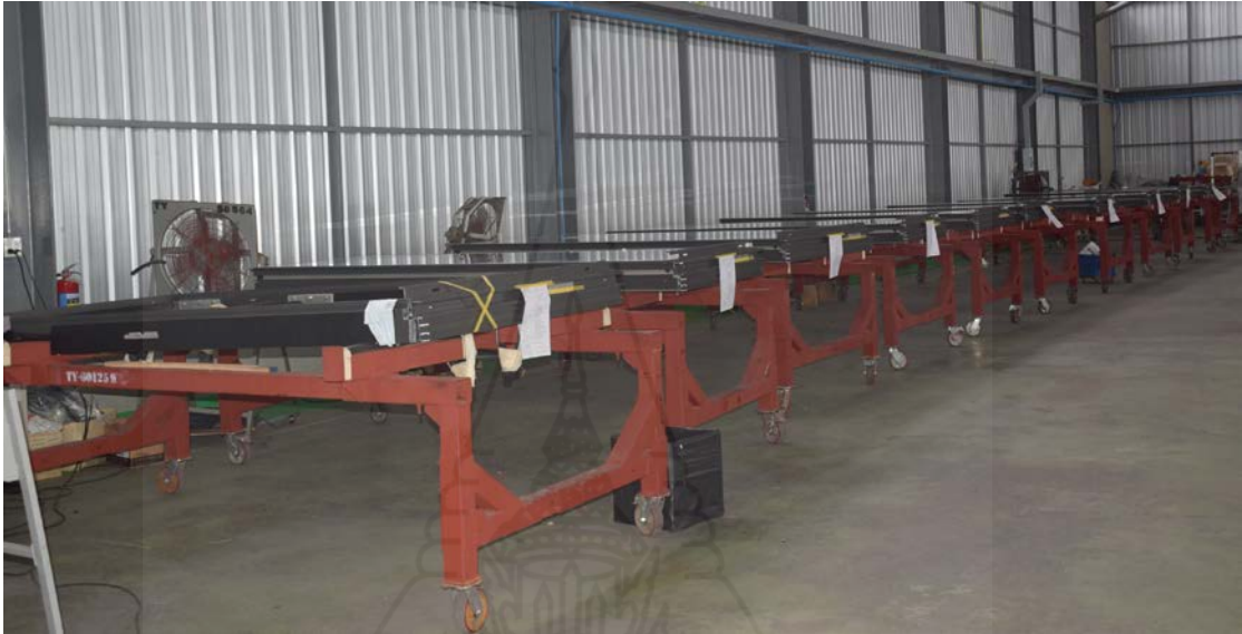
ภาพที่ 4.35 สายการผลิตติดตั้งกระจกและยาซีลีโคนแบบใช้รถเข็นชนิดเคลื่อนที่ได้
