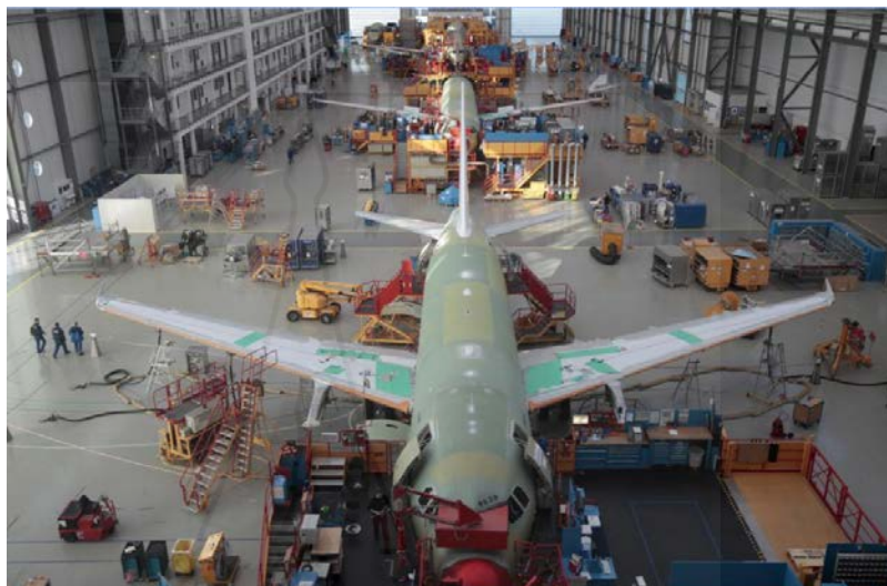
ภาพที่ 2.12 รูปแบบการวางผังโรงงานแบบตำแหน่งของงานอยู่กับที่ (Fixed Position Layout) ของโรงงานผลิตเครื่องบินแอร์บัส
