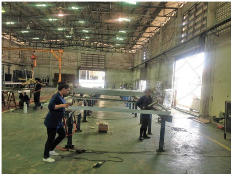
ภาพที่ 4.18 การนำกรอบอลูมิเนียมขึ้นวางบนรางลูกกลิ้งลำเลียง
