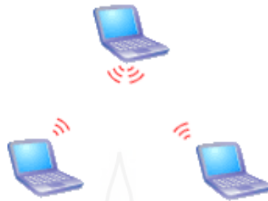
ภาพที่ 2.3 แสดงการเชื่อมต่อแบบกลุ่มส่วนตัว(Ad-Hoc)
