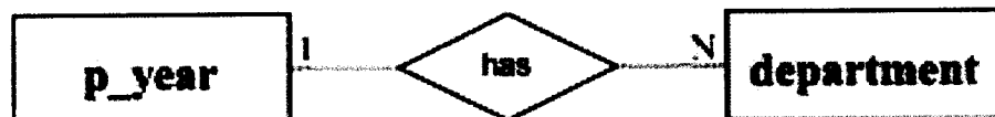
ภาพที่ 4.23 แสดงความสัมพันธ์ระหว่างเอนทิตี p_year และเอนทิตี department
