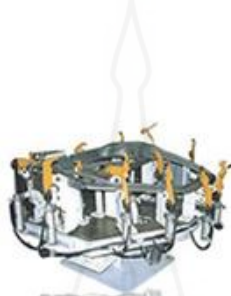
ภาพที่ 2.9 อุปกรณ์จับยึดเพื่อการประกอบรถยนต์และตรวจสอบคุณภาพ
